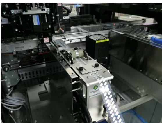
フィルム フィーダー（三井金属計測機工製）
