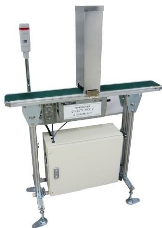
赤外線異物検出装置（三井金属計測機工製、左：カメラ方式、右：センサ方式）
