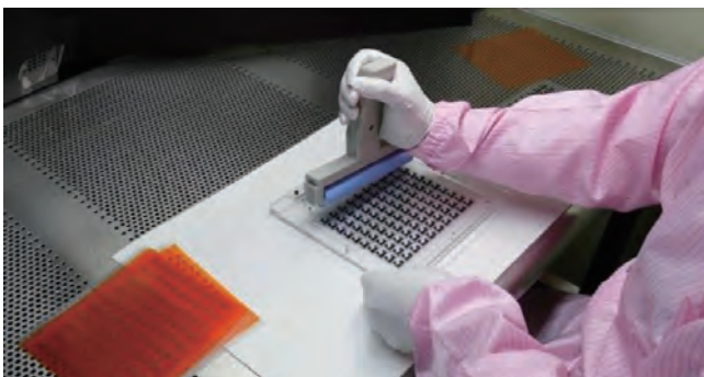
治具を使った微細ワークの貼り付け作業
